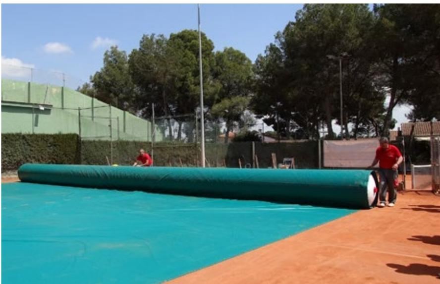
Esta lona tiene la particularidad de que dispone de un sistema para el extendido y recogida de la misma. El sistema air roller está patentado y CELABASA es el distribuidor exclusivo en España.
